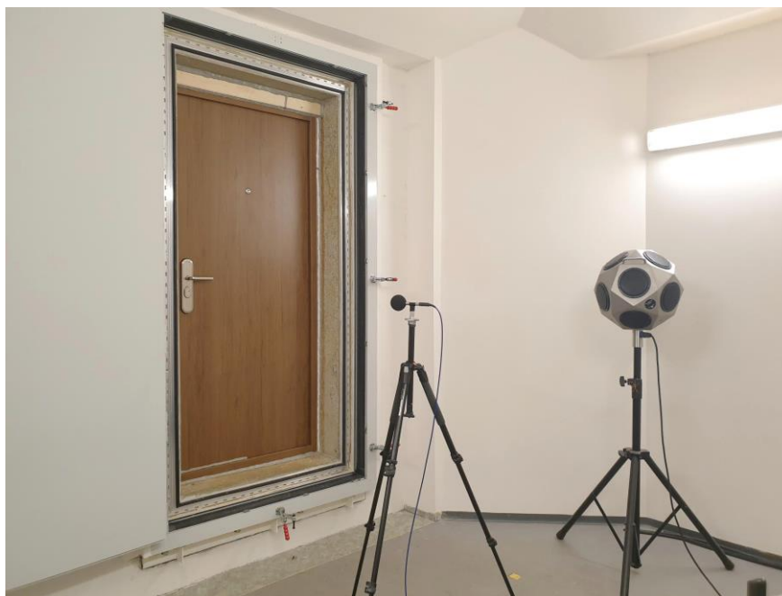
Celkový pohľad na dvere osadené v deliacej konštrukcii počas merania
